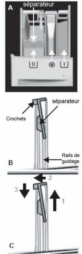
Un espace doit être présent entre le séparateur et le bas de la chambre de lavage principale, si le séparateur a été correctement installé (Illus. "B" et "C")
