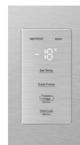
Écran de contrôle digital en façade
