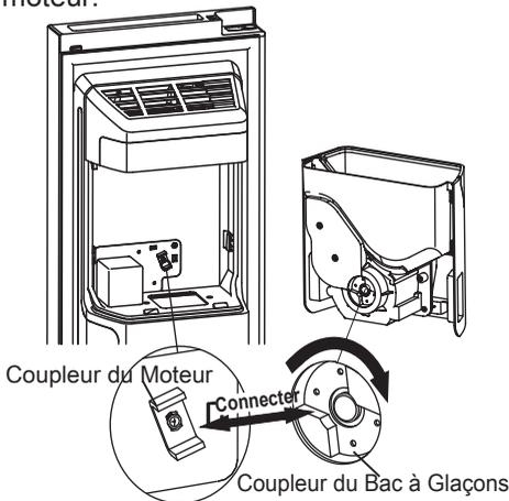
● Si vous souhaitez plus de place pour stocker des aliments, vous pouvez remplacer le Bac à Glaçons avec le compartiment de stockage. Le bouton « Ice Off » doit être activé pour s'assurer que la fabrique à glaçons est désactivée.
