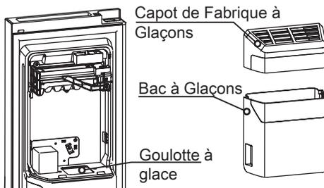
● Le premier lot de glaçons après l'installation peut être petit, car de l'air est entré dans la ligne d'eau. L'air sera purgé pendant une utilisation normale. Si les glaçons sont toujours petits, veuillez contrôler si de l'eau circule dans la ligne, ou si la valve à eau est suffisamment ouverte, ou si l'eau est correctement à haute pression.
