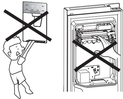
● Une conduite est installée entre le dispositif à glaçons et le bac à eau; ne désassemblez pas l'ensemble par vous-même. Nous vous conseillons pour cela de prendre contact avec une personne qualifiée.
