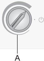
A Bouton du thermostat : réglage de la température et Marche/Arrêt
