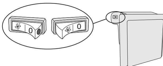
Lorsque le ventilateur et l'ioniseur sont en marche, un point rouge est visible sur l'interrupteur.
