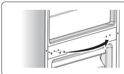
10. Faites basculer le réfrigérateur délicatement vers l'arrière, retirez l'élément ③ puis retirez les vis ④.
