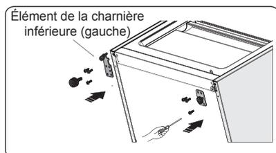
14. Placez le réfrigérateur en position verticale et faites délicatement glisser la goupille de la charnière basse de la porte inférieure, et maintenez le tout en position. Faites pivoter la charnière centrale de 180°, remplacez la rondelle présente sur l'axe du côté inférieur, ajustez la charnière central dans la bonne position et installez le tout, en vous assurant que la porte inférieure est bien sécurisée.
