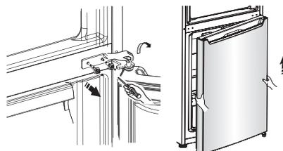
8. Placez la porte inférieure sur une surface lisse et régulière, le panneau de la porte vous faisant face. Desserrez la vis ③ et les éléments ② et l'élément ①. Installez la butée de porte de remplacement de la porte gauche
