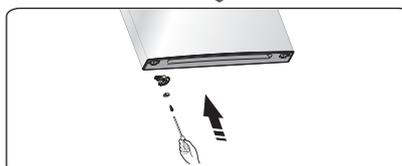
9. Remplacez les protections des trous de vis ainsi que les vis du cache central, de gauche à droite (comme indiqué sur l'illustration suivante).
