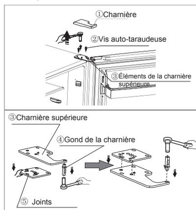
3. Desserrez le gond de la charnière ④ au moyen d'une clé, et inversez le sens d'installation, puis serrez le tout afin de fixer l'ensemble. Retirez le joint ⑤ et changez le sens d'installation.
