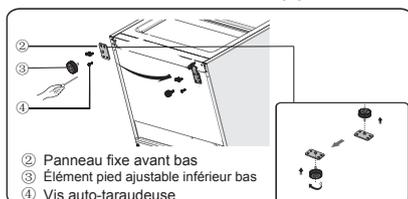
13. Remplacez les éléments réassemblés lors des étapes 11 et 12, remplacez la pièce ① en la faisant passer de gauche ② à droite, puis vissez-les ④. Enfin, installez la pièce ③.
