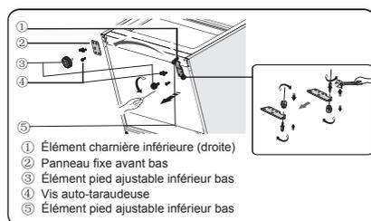
11. Retirez l'élément ⑤ de la goupille de la charnière inférieure, desserrez la goupille, puis inversez-la de côté. Serrez-la ensuite afin de la fixer dans cette position, puis installez l'élément ⑤ sur la goupille de la charnière inférieure.
