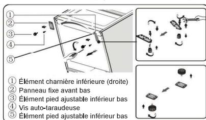
12. Retirez l'élément ⑤ de la goupille de la charnière inférieure, desserrez-la, changez-la de côté et serrez-la pour la maintenir en place, puis installez l'élément ⑤ sur la goupille de la charnière inférieure.
