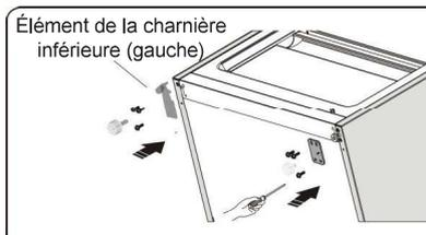
15. Faites glisser la porte inférieure sur la goupille de la charnière inférieure et maintenez le tout en position. Faites pivoter la charnière intermédiaire de 180°, déplacez la rondelle de l'axe vers la partie basse, ajustez la charnière intermédiaire dans la bonne position et installez-la en vérifiant que la porte inférieure est bien en place.
