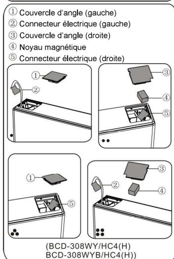
7. Dévissez la vis ③ et retirez l'élément ② puis l'élément ①. Installez la butée gauche de la porte de remplacement ④ (fournie dans l'emballage plastique) ainsi que l'élément ② (butoir) du côté gauche au moyen de la vis ③. Conservez l'élément ① avec l'appareil à titre de référence.
