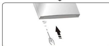
10. Remplacez les trappes de vis en les faisant passer du côté gauche au côté droit (comme sur l'illustration ci-dessous).
