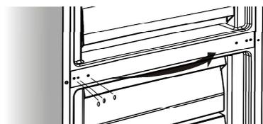
11. Inclinez le réfrigérateur vers l'arrière, retirez l'élément ③ puis retirez la vis ④.
