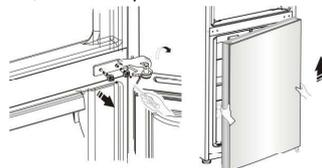
9. Placez la porte inférieure sur une surface molle, la face avant vers vous. Desserrez la vis ③ et retirez les éléments ② et ①. Installez la butée gauche de la porte de remplacement ④ (fournie dans l'emballage plastique) ainsi que l'élément ② (butoir) du côté gauche au moyen de la vis ③. Conservez l'élément ① avec l'appareil à titre de référence.
