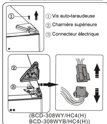
3. Retirez les vis ① et la charnière ②. Puis, faites passer le connecteur ③ par la fente de la charnière ②. (Tenez la porte supérieure pendant l'installation)
