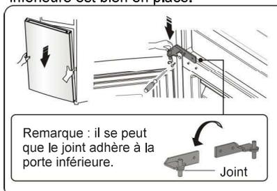
16. Déplacez la porte supérieure dans une position adéquate, puis fixez l'élément ② au moyen des vis ①. Avant de fixer l'élément ②, faites passer le connecteur ③ par la charnière ② en vous reportant à l'étape 3. (Maintenez la porte supérieure manuellement pendant l'installation)
