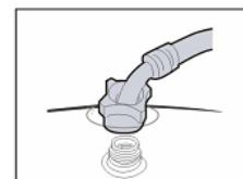
Si nécessaire rectifiez la position du raccord de vidange en vissant la bague de serrage placée à l'arrière de l'appareil.
