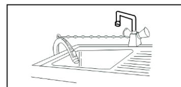
Dans un conduit de vidange (ou dans une dérivation de la vidange d'un lavabo) dont la distance au sol doit être comprise entre 70 et 125 cm. Il est indispensable de prévoir une entrée d'air à l'extrémité du tuyau de vidange pour éviter tout siphonage éventuel. En outre, le tuyau de vidange ne devra former aucun coude. Il devra être placé au niveau du sol, la crosse devra se trouver à la hauteur indiquée précédemment.
