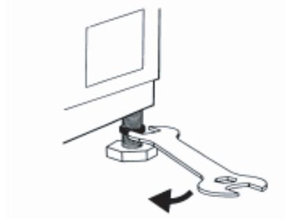
**Étape 2 :** Soulevez légèrement la machine et ajustez la hauteur du pied, en le faisant pivoter.
