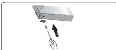
7. Déversez les vis auto-taraudeuse à collerette, utilisés pour maintenir en place l'élément de la charnière intermédiaire, puis retirez l'élément maintenant la porte en place.
