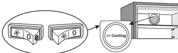
Lorsque le ventilateur est en marche, un point rouge est visible sur l'interrupteur.
