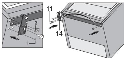
Fixez la charnière (14) sur le côté opposé à l'aide des vis. Les vis doivent être fixées dans l'ordre indiqué sur la figure ci-dessous. Tout d'abord, serrez la vis 1, puis les vis 2. Ensuite, vissez les pieds réglables (11).
