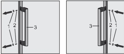
À noter : si votre modèle dispose d'une poignée, positionnez-la du côté opposé en suivant les instructions ci-dessous.
