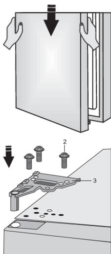
Placez la porte sur la charnière inférieure et utilisez les vis (2) pour fixer la charnière supérieure (3). Maintenez la porte en place tout en la positionnant.
