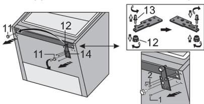
Dévissez les trois vis de la charnière inférieure (14) et retirez-la. Retirez le pied supplémentaire (12) de l'axe de charnière inférieure (13). Dévissez la goupille (13) de la charnière inférieure et vissez-la sur le côté opposé de la charnière, avec le pied supplémentaire (12).
