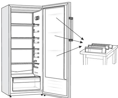
Placez l'appareil en position verticale. Ouvrez la porte et retirez les balconnets (pour éviter de les endommager pendant l'opération). Fermez ensuite la porte.
