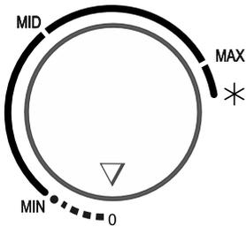
Pour mettre l'appareil à l'arrêt, tournez le bouton **A** en sens inverse et positionnez le curseur en face de l'icône **0**. (Attention : l'appareil demeure sous tension, c'est-à-dire que le courant électrique est toujours présent).
