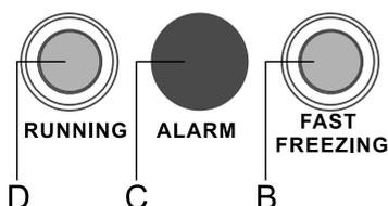
Si la température à l'intérieur de l'appareil est trop élevée, le voyant **C** reste allumé en permanence ou clignote. Il s'éteint lorsque l'appareil est descendu à une température suffisamment basse pour garantir la bonne conservation des aliments.
