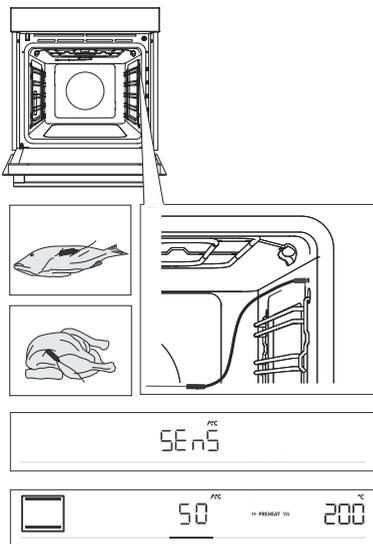
1 Enfoncez l'extrémité métallique de la sonde dans la partie la plus épaisse de l'aliment.
