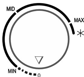
Pour mettre l'appareil à l'arrêt, tournez le bouton **A** en sens inverse et positionnez le curseur en face de l'icône **O**. (Attention : l'appareil demeure sous tension, c'est-à-dire que le courant électrique est toujours présent).
