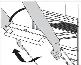
**3** Fermez doucement la porte jusqu'à ce que les petits leviers soient alignés avec les fentes. Soulevez légèrement la porte et dégagez-la des logements des charnières, de chaque côté de l'appareil.
