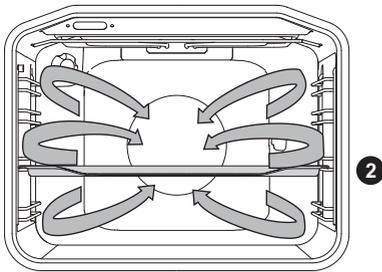
La résistance circulaire et le ventilateur fonctionnent simultanément. Le ventilateur situé au fond du four fait circuler autour du rôti ou du gâteau la chaleur produite par la résistance circulaire.
