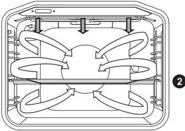
Le grill et le ventilateur fonctionnent simultanément. Ce mode convient à la cuisson de la viande, du poisson et des légumes.
