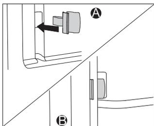
Lorsque vous installez les glissières télescopiques totalement extensibles et les parois catalytiques amovibles, placez une extrémité des clips fournis dans les trous inférieurs situés sur les parois inamovibles du four, puis insérez les tiges verticales des gradins dans l'autre extrémité des clips. Ces derniers servent à maintenir les grilles latérales bien en place.
