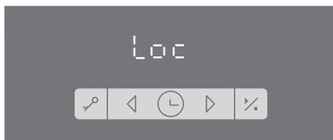
**3** Pour votre sécurité, la porte du four se verrouille automatiquement au bout d'un certain temps. Le mot "Loc" apparaît sur l'afficheur (pendant 3 secondes).
