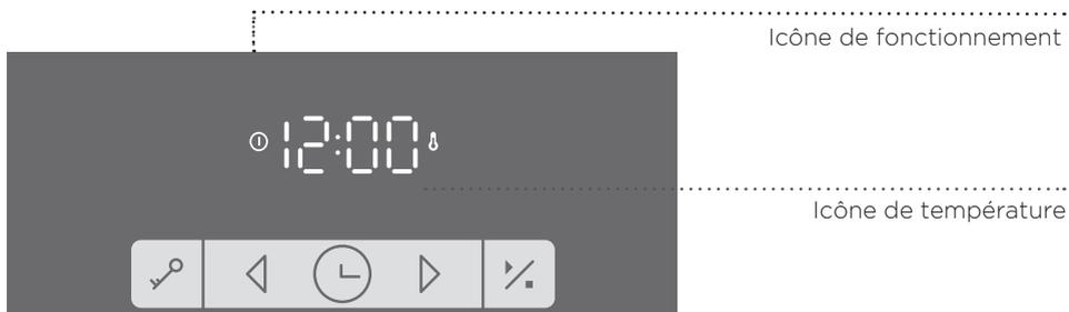
Pendant que le four chauffe, l'icône de température clignote. Lorsque l'appareil a atteint la température réglée, l'icône reste allumée et un signal sonore bref retentit.
