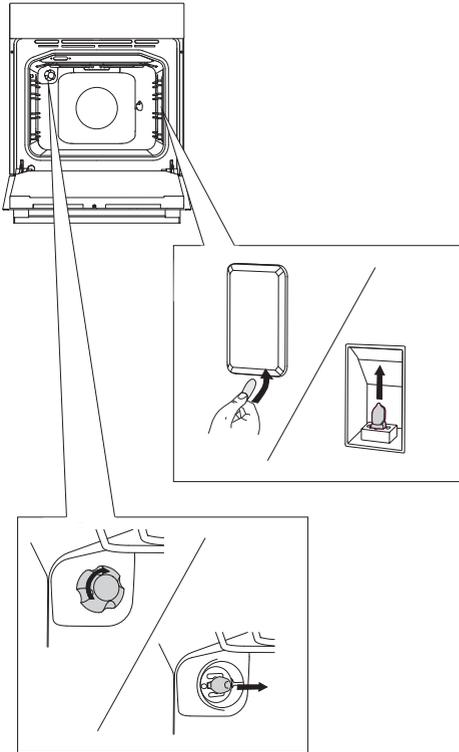
Avec un tournevis plat, soulevez le couvercle de l'ampoule, enlevez-le, puis retirez l'ampoule.
